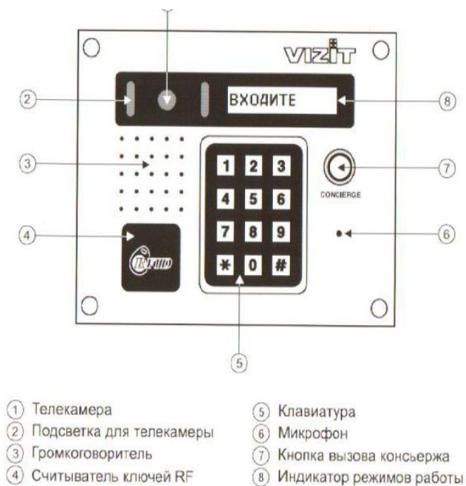
Рис. 5. Внешний вид и органы управления блока «VIZIT».
