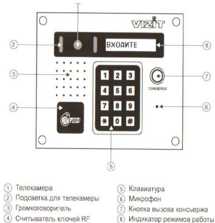
Рис. 5 Внешний вид и органы управления блока.
