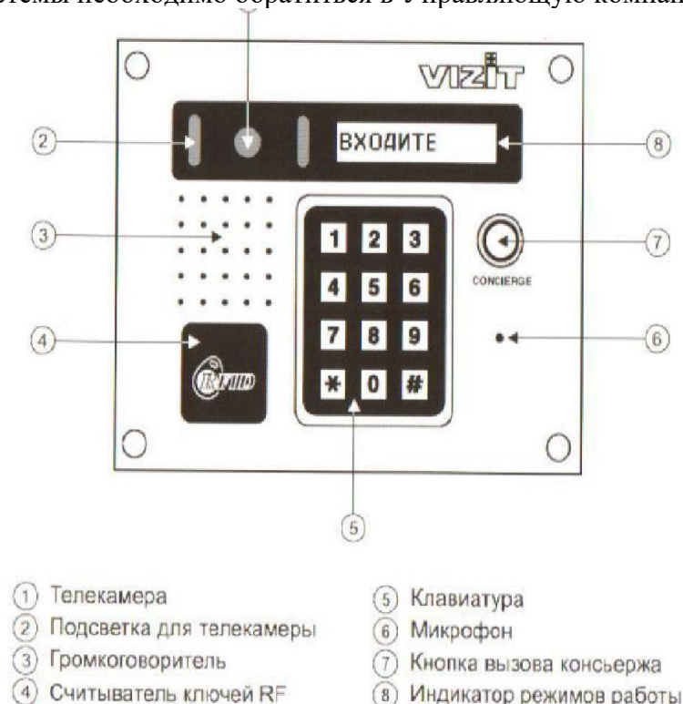
Рис. 5 Внешний вид и органы управления блока.
