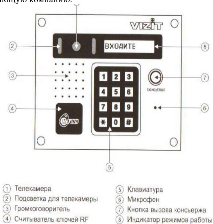
Рис. 5 Внешний вид и органы управления блока.
